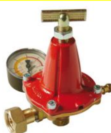
Riduttore di alta pressione 0-4 bar taratura variabile con manometro Capacità 12 Kg/h
